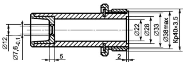
Данные устройства, имитирующего фильтр: масса 300 г, равномерно распределенная по всей длине; сопротивление потоку воздуха 1 кПа при расходе постоянного потока воздуха 95 дм<sup>3</sup>/мин; общая длина 96 мм
