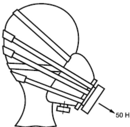
Рисунок 1 - Размещение соединительного узла при испытании
